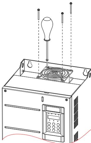
3. 将风扇罩、风扇脱离机体，完成风扇拆卸。
