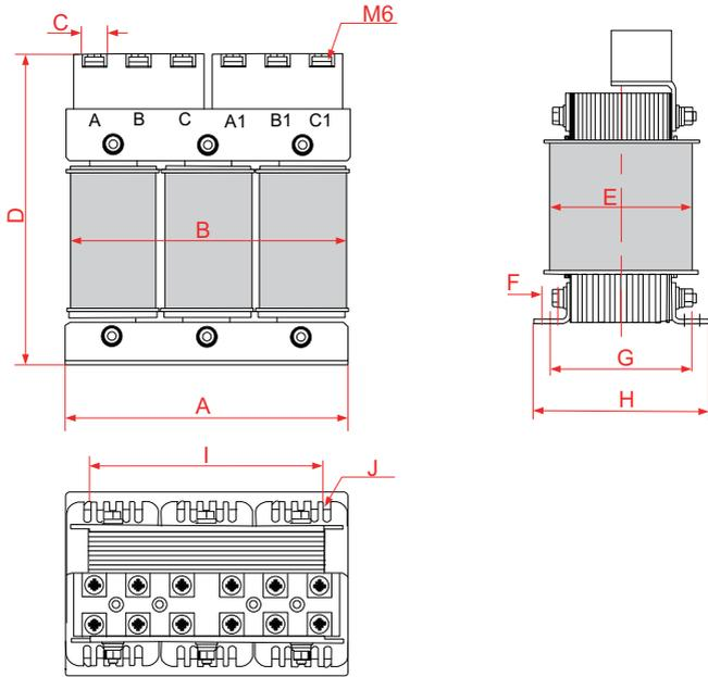
图5-17 40A / 50A(1.2mH)交流输入电抗器尺寸图
