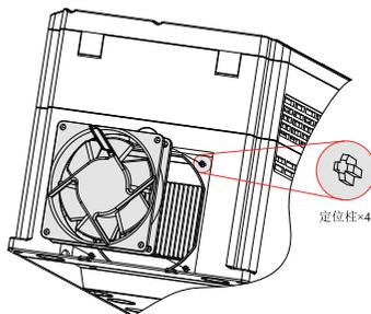
3. 将风扇罩上的两个小卡扣插入机体扣槽，轻轻按下固定卡扣。
