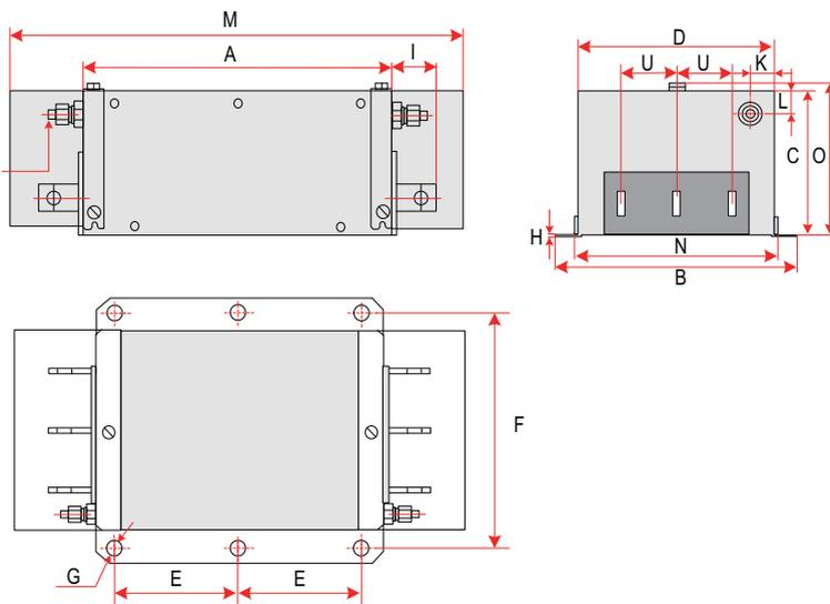
图5-30 FN 3359系列150-2500A滤波器尺寸图(单位: mm)
