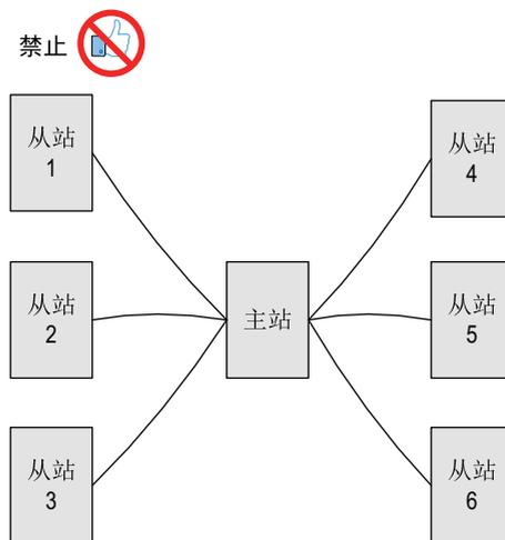
图6-8 星形接线方式（不推荐使用）
