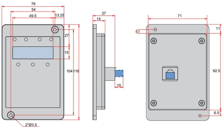
图5-38 外引LED操作面板外形尺寸 (单位: mm)
