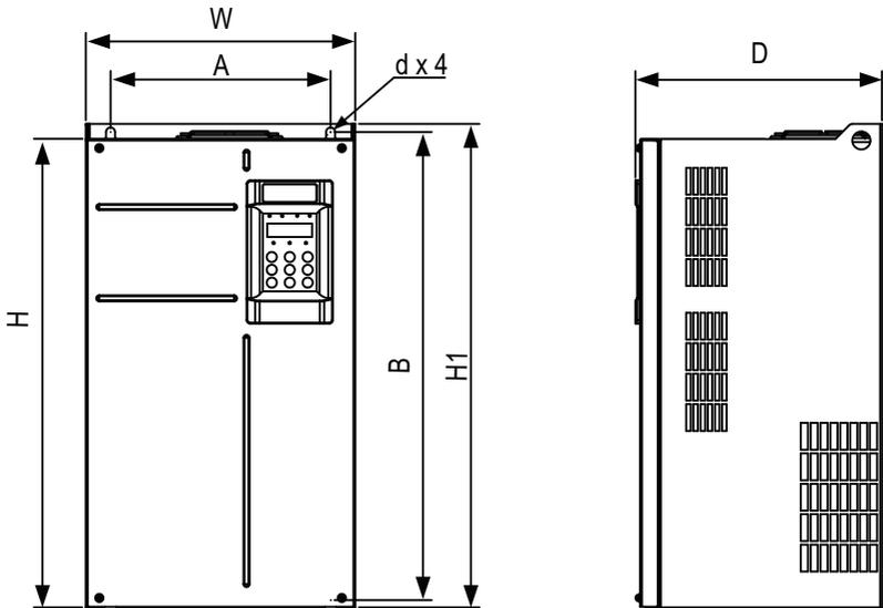
图3-3 T7~T9外型尺寸及安装尺寸示意图
