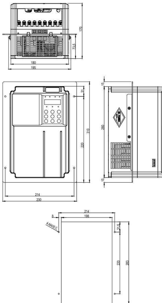
图5-3 MD500-AZJ-A1T4中部安装支架及开孔尺寸
