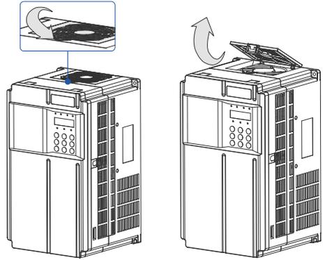
2. 将风扇向上提起后，将电源线插头从插座上拔下，完成拆卸。
