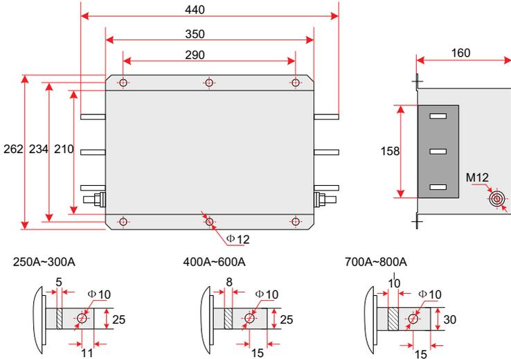
图5-33 强力滤波器250~800A尺寸图(单位: mm)
