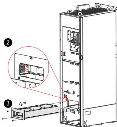
3. 拆下每个风扇罩上的四颗固定螺钉，完成风扇拆卸。
