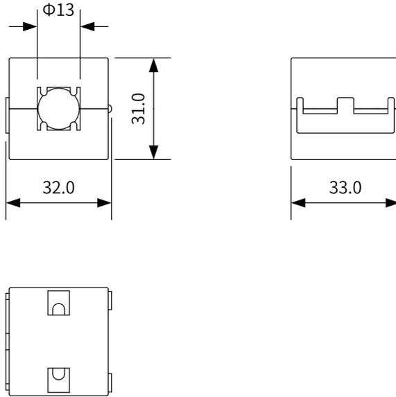
图5-37 磁扣尺寸图
