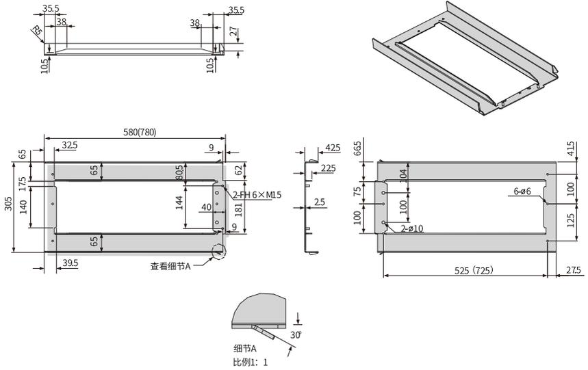
图5-9 T10底部安装支架尺寸
