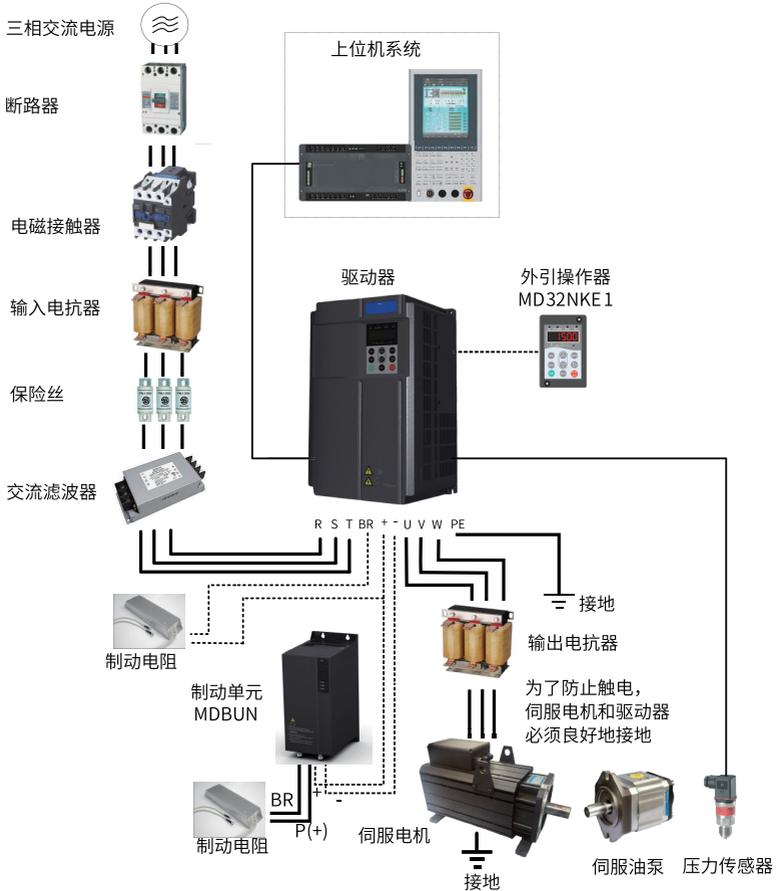
图4-1 系统构成示意图
