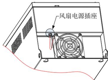
2. 用螺丝刀将风扇罩上的四颗固定螺钉卸下。
